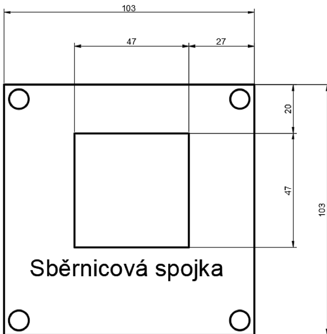
Obrázek 3.13 Šablona pro výrobu krabičky pro sběrníkovou spojku
