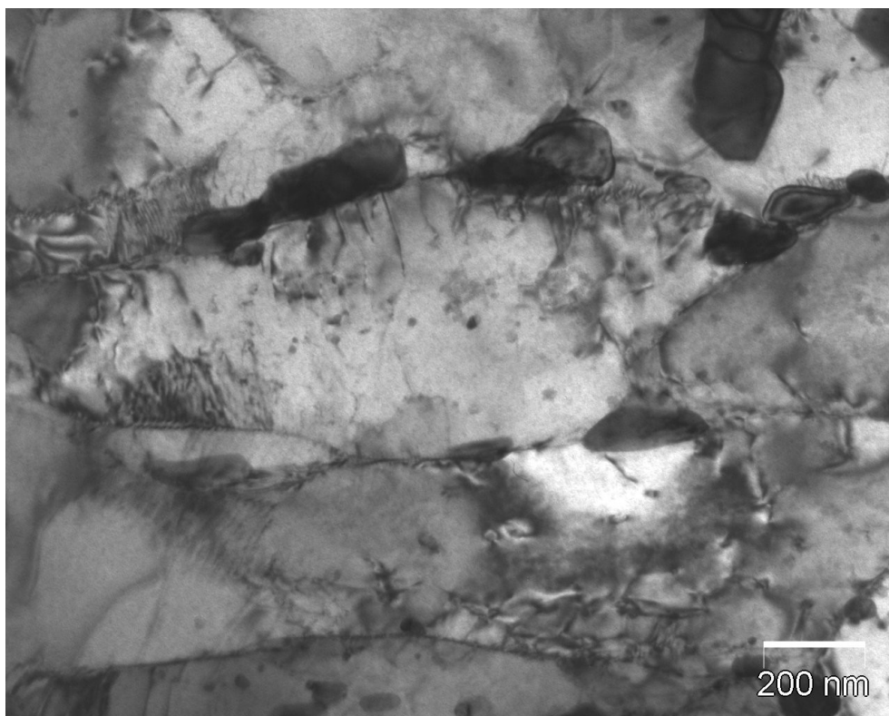
Obr. 31: Karbidy v mikrostruktuře plechu 25 mm AR, fólie TEM.
