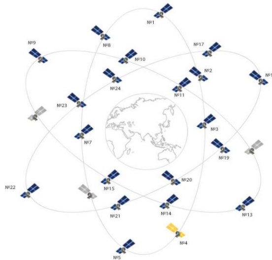
Obr. 12 Schéma konstelace družic GLONASS [57]
