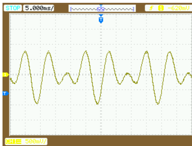
Obr. 22 Záznam směšovače s funkcí otočení fáze
