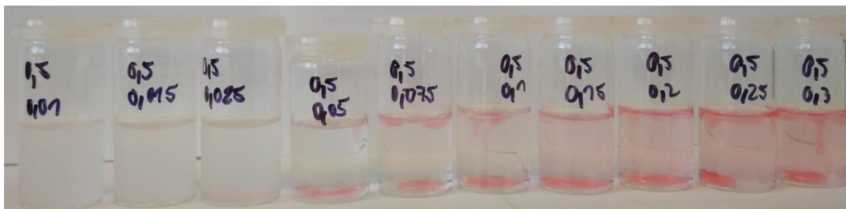
Obr. 28: Gely 24 hodin po přípravě, CTAB, 0,5% hyaluronan, 2. opakování.
