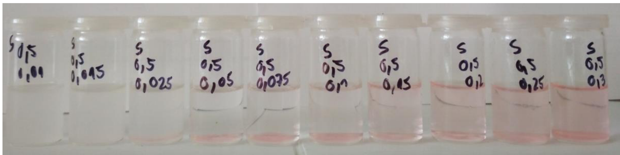
Obr. 18: Gely 24 hodin po přípravě, Septonex, 0,5% hyaluronan, 2. opakování.
