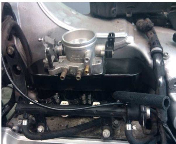
Obr 12: Upravené sání Motocyklu BMW k 1200 RS [1]
