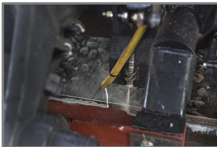
Obr. 3-14 Aplikace sanditu kolejovým vozidlem [30]
