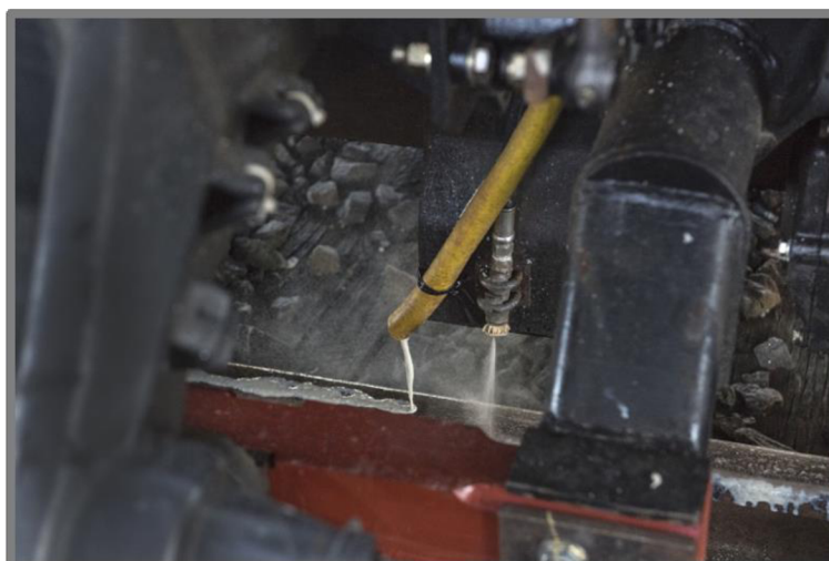
Obr. 3-14 Aplikace sanditu kolejovým vozidlem [30]
