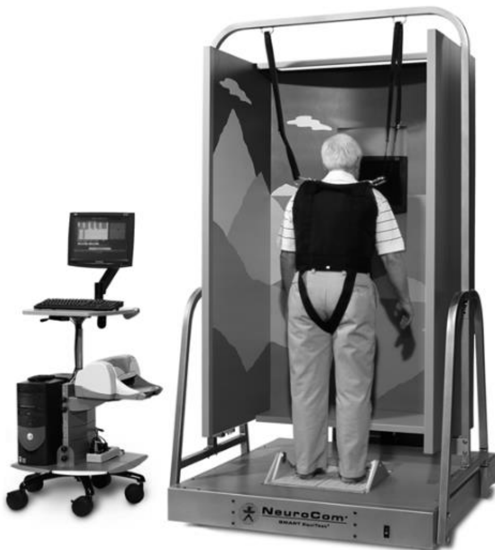
Obrázek 3 – Posturograf NeuroCom® Výchozí poloha pacienta na silové plošině posturografu (Barros de Oliveira et al., 2008, p. 1222).
