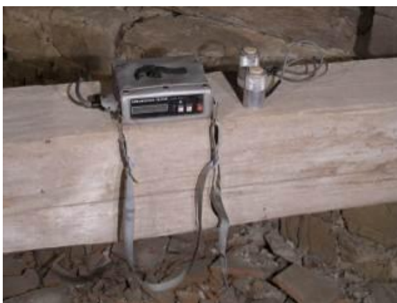
Obrázek 16 Detail přístroje Arborsonic Decay Detektor (KLOIBERKA, KOTLÍNOVÁ, 2010)
