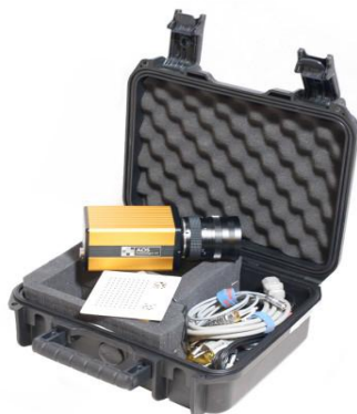
Obrázek 21 Typická konfigurace jedno-kamerového systému (VAJĎÁK, 2011)
