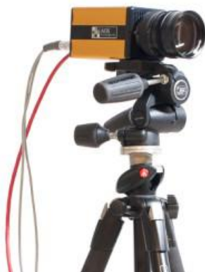
Obrázek 22 Připojení kamery na stativ (VAJĎÁK, 2011)
