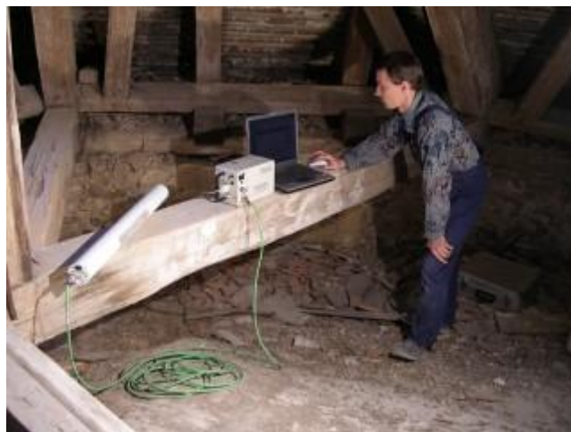
Obrázek 13 Odporové vrtání v praxi pomocí Resistographu (KLOIBER, KOTLÍNOVÁ 2010)
