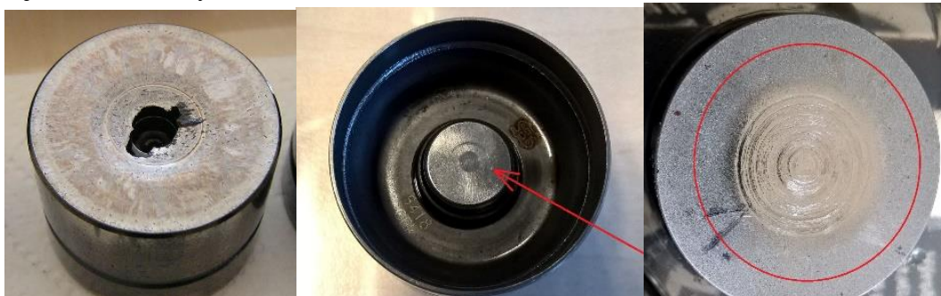
Obrázek 4 - znaky poškození hydraulických zdvihátek – archiv autora
