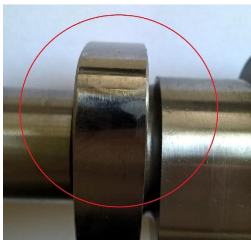
Obrázek 5 - znak poškození vačky – archiv autora
