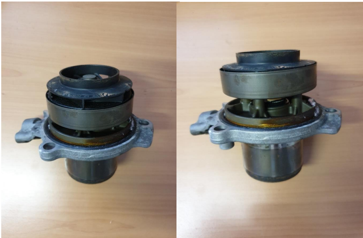
Obrázek 17 - princip vypínání vodního čerpadla – archiv autora
