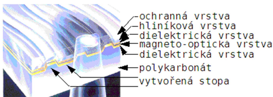
Obrázek 15 Znárodnění drážky a jednotlivých vrstev optomagnetického disku (13)
