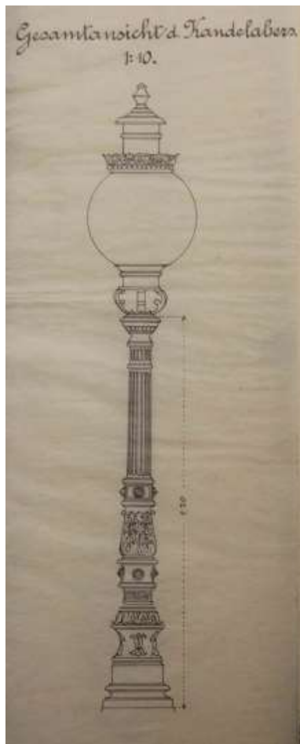
Obrázek 43: Nádraží Liberec – výkres kandelábrového osvětlení
