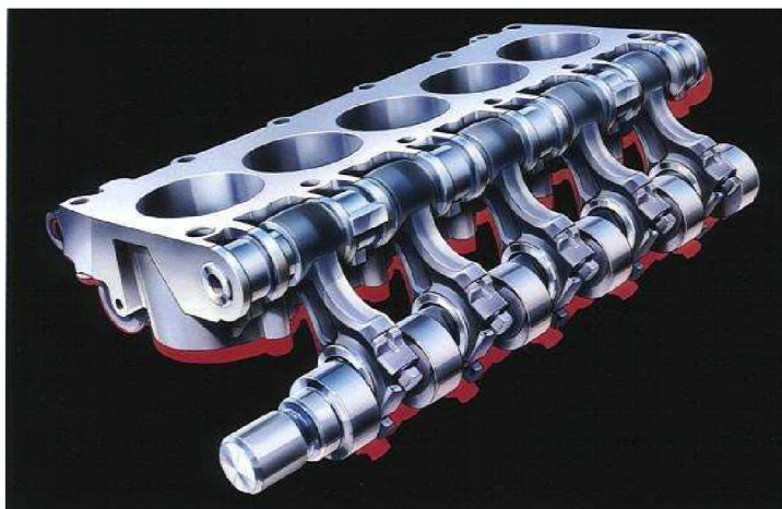
Obr. 4.5 Mechanismus změny kompresního poměru [37]
