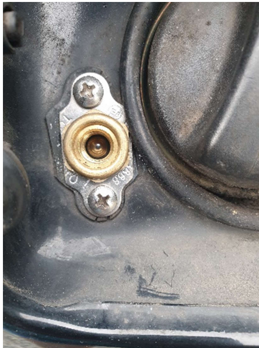
Obrázek 7: Plnicí hrdlo ukončeno závitem, (zdroj: vlastní).
