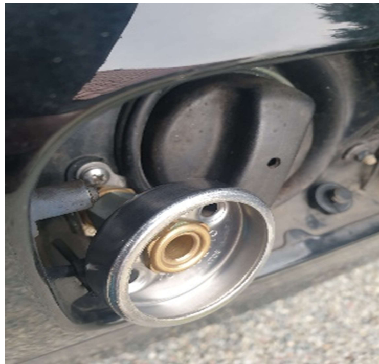
Obrázek 9: Namontovaná redukce před tankováním. (zdroj: vlastní)
