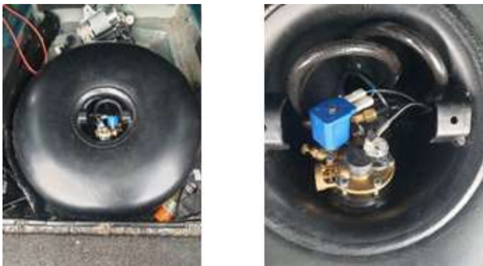
Obrázek 11: (a) LPG nádrž a (b) multiventil. (zdroj: vlastní)
