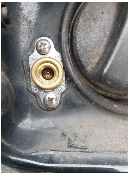
Obrázek 7: Plnicí hrdlo ukončeno závitem, (zdroj: vlastní).
