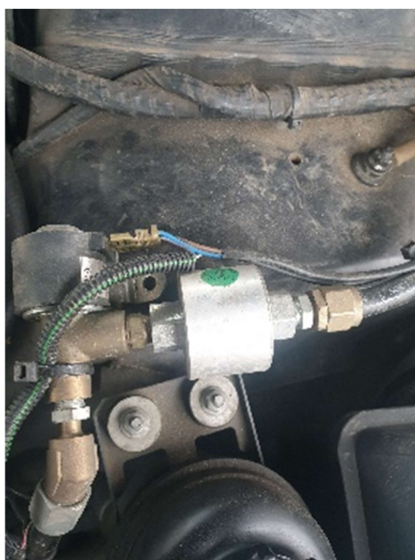
Obrázek 18: Filtr na kapalnou fázi. (zdroj: vlastní)
