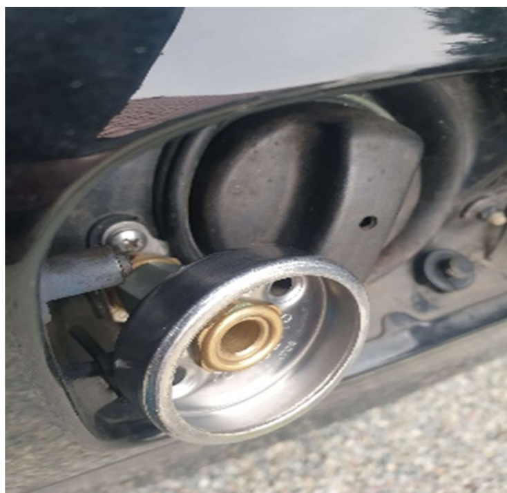
Obrázek 9: Namontovaná redukce před tankováním. (zdroj: vlastní)
