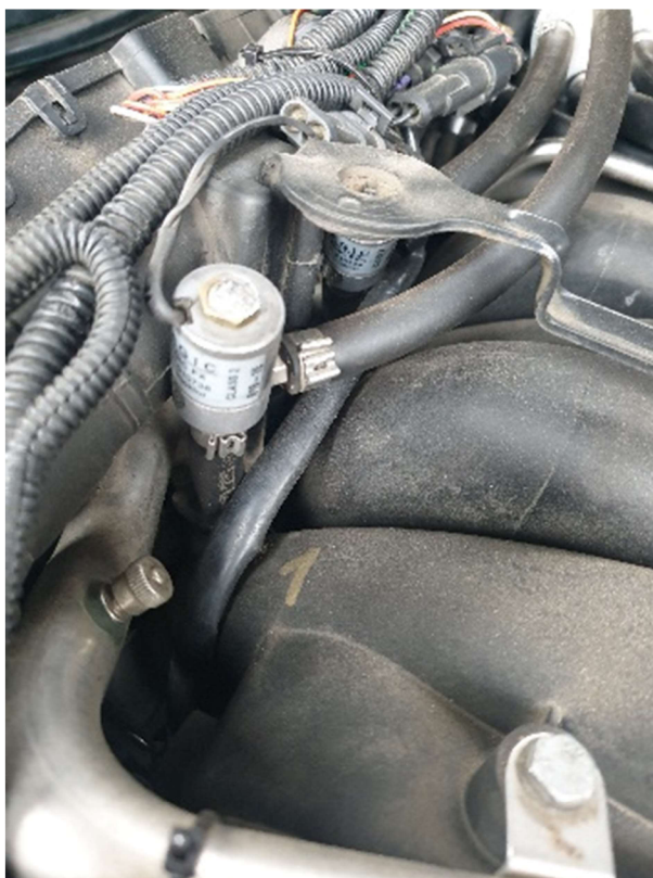
Obrázek 14: Vstřikovač. (zdroj: vlastní)
