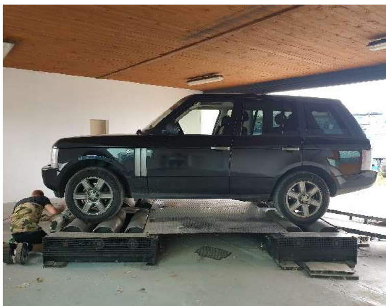
Obrázek 20: Vozidlo na válcové zkušebně. (zdroj: vlastní)
