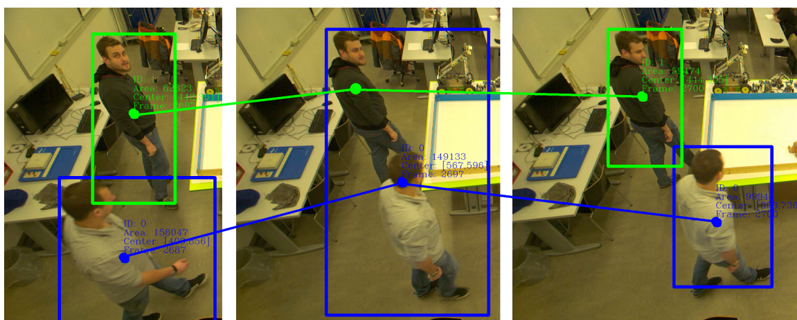
Obrázek 37: Spárování objektů napříč třemi snímky pomocí maďarské metody s využitím kalmanova filtru pro predikci polohy objektu.
