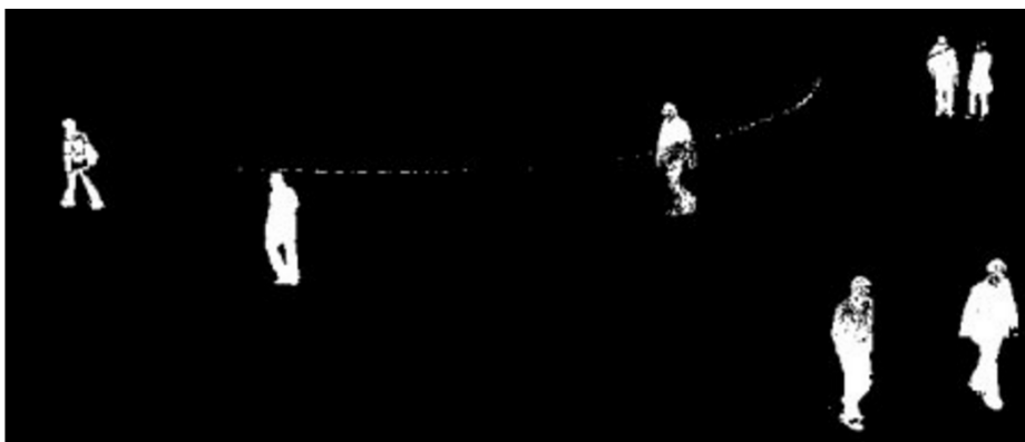
Obrázek 7: Výstup rozdílové metody MOG. Zdroj: (OpenCV 3.0, 2014)
