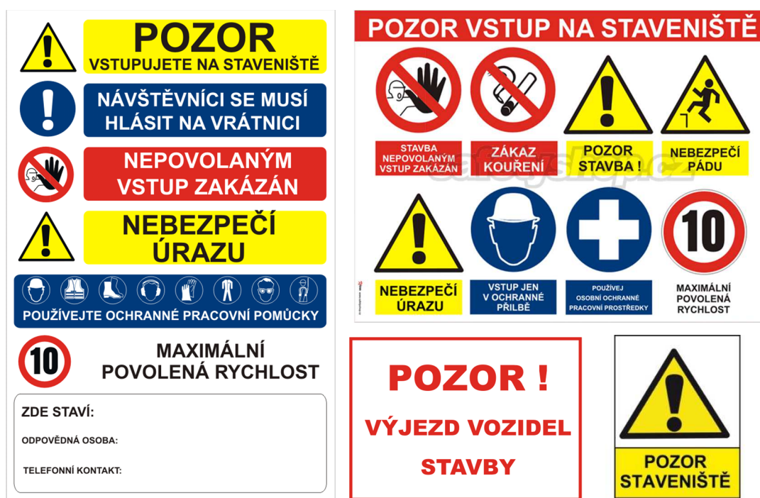
Obrázek 5 Značky na vjezdu do stavby, v jeho okolí a na oplocení
