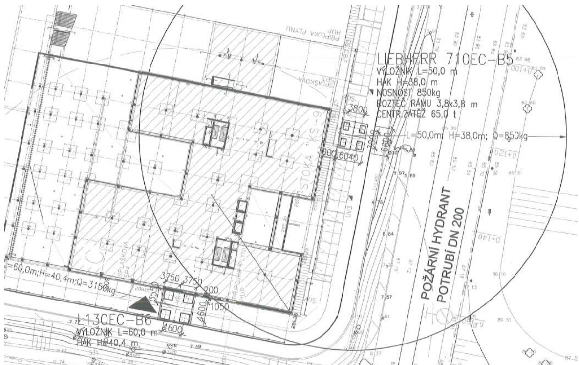
Obrázek 38 Schéma půdorysného uspořádání jeřábů
