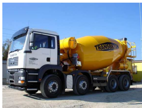
Obrázek 22 Autodomíchač AM 9 FHC C3 HDL
