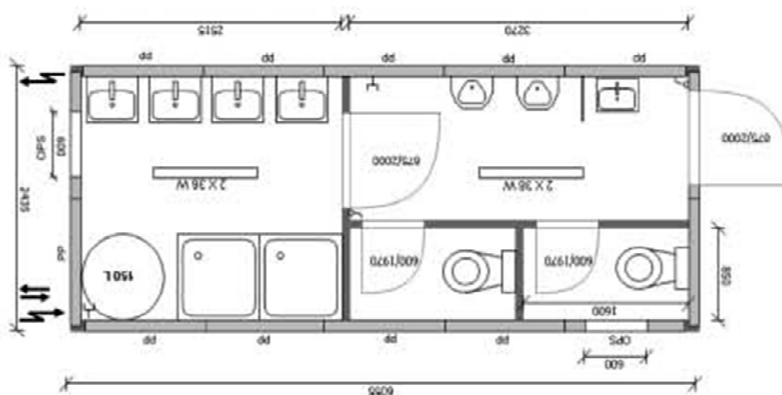
Obrázek 3 Schéma sanitární kontejner MBS 20' K - kombinovaný
