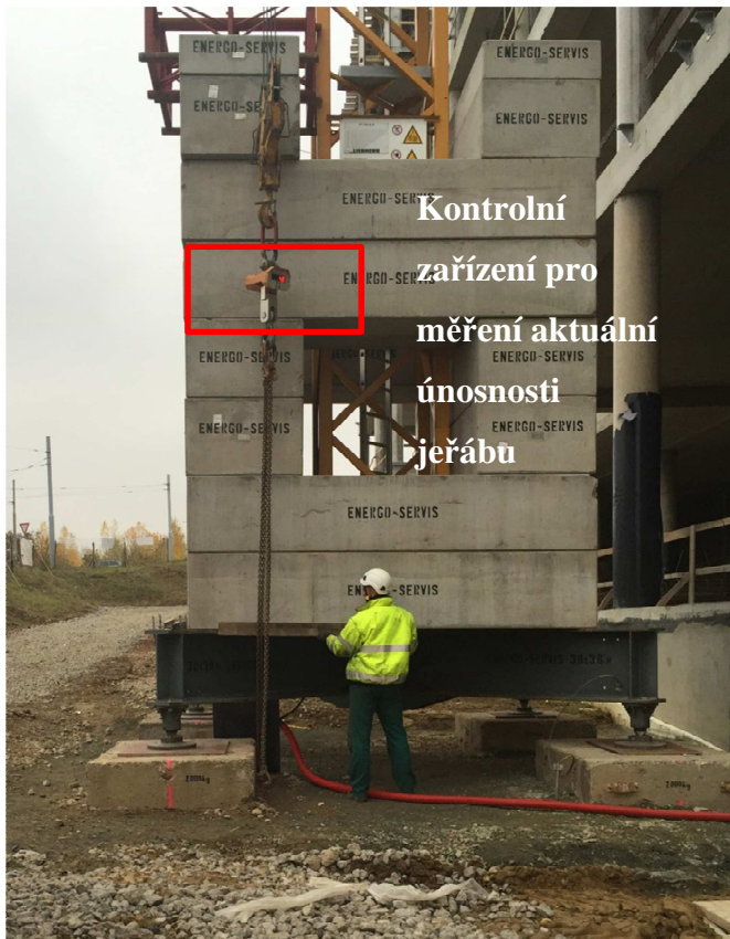
Obrázek 52 Statická zátěžová zkouška jeřábu
