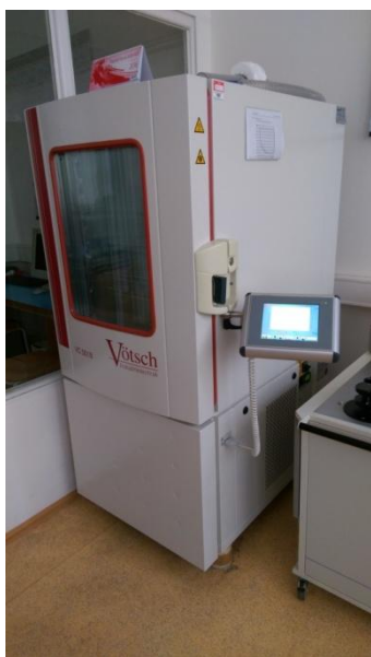
Obrázek č. 11 a 12: a) Klimatická komora Vötsch VC0018, b) nastavení teploty a vlhkosti v komoře
