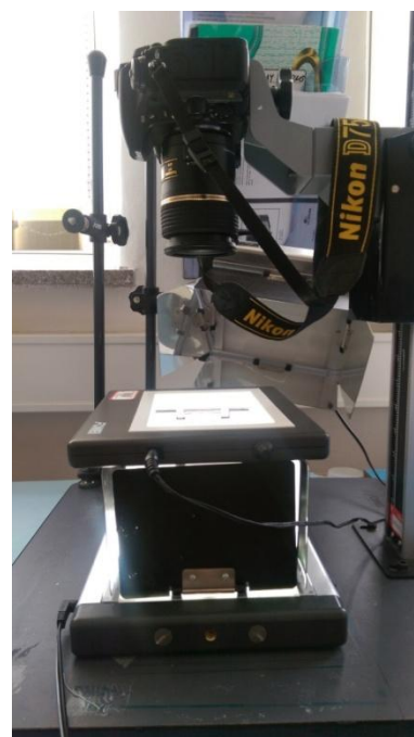
Obrázek č. 61: a) fotografování textilie, b) uchycení fotoaparátu
