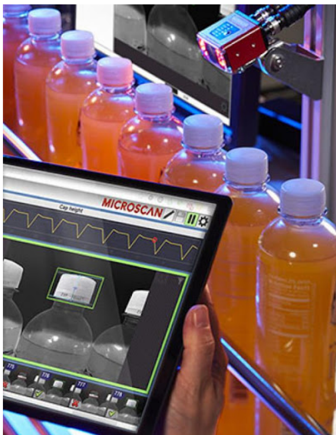
Obrázek 2.1: ukazuje příklad běžného využití automatické vizuální inspekce. Na výrobní lince se v tomto případě nacházejí plastové lahve s nápoji, které jsou snímány kamerou. Vedle linky vidíme uživatele s tabletem na němž běží aplikace s GUI pro definici konfigurace kontrolního systému. Z obrázku vyplývá, že v tomto případě systém kontroluje to, zda jsou zátky lahví správně zašroubovány. Převzato z [4].
