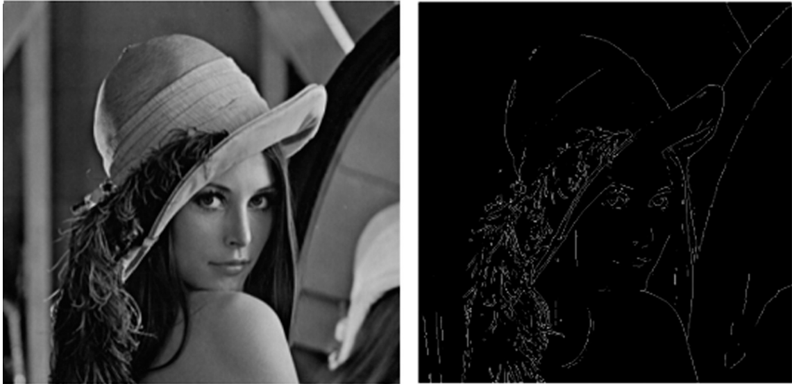
Obrázek 3.2: demonstruje jak se liší předzpracovaný binární obraz vlevo od původního vpravo. Binární obraz je vhodným vstupem pro Houghovu transformaci. Převzato z [9]
