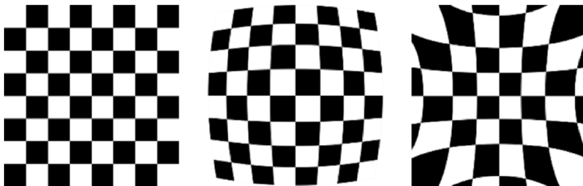
Obrázek 3.4: popisuje vzhled kalibrační šachovnice. Obrázek vlevo ukazuje nezkraslený obraz. Na prostředním obrázku lze vidět příklad soudkovitého zkreslení a na tom vpravo poduškovité zkreslení. Převzato z [5].
