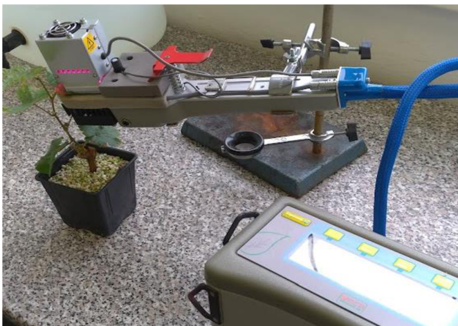
Obr. č. 31 – Měření pomocí přístroje infračerveného analyzátoru plynů LCpro+ (dostupné z: autor práce)
