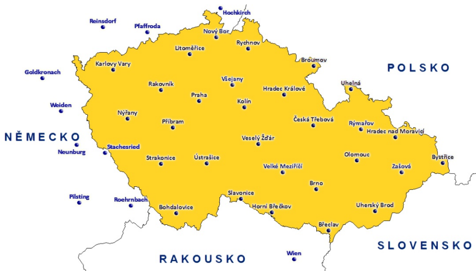
Obr. 6: Rozmístění permanentních stanic sítě Trimble VRS Now. [18]
