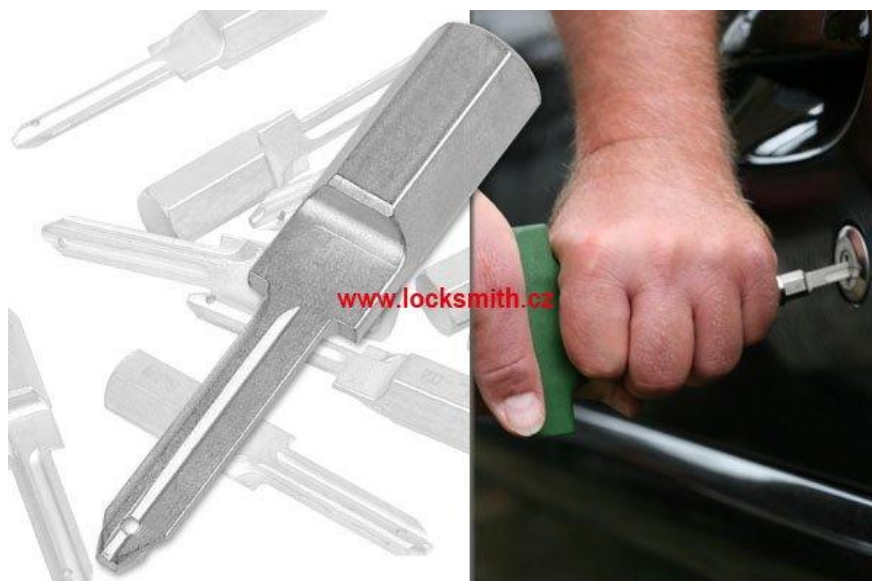
Obrázek 8: Příklad tzv. lámáku (Power key) a práce s ním
