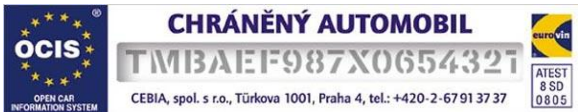
Obrázek 23: Příklad označení skla kódem se samolepkou OCIS/CEBIA
