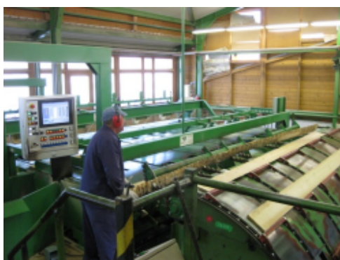
Obr. 9: Automatický omítací uzel
