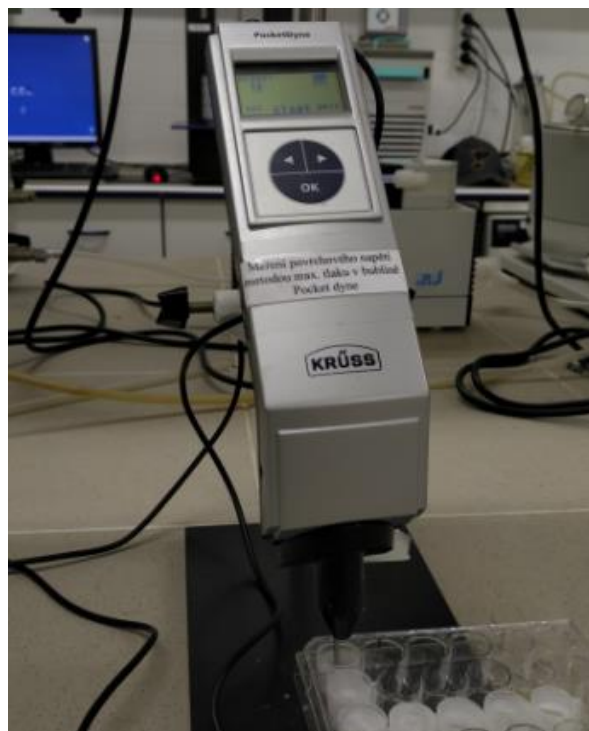
Obrázek 26: Tenziometr PocketDyne (Krüss) pro měření povrchového napětí roztoků tzv. bublinkovou metodou
