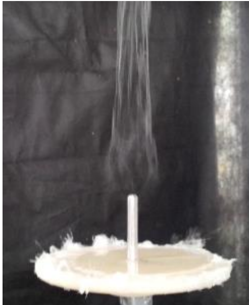
Obrázek 12: Formování svazku vláken ve volném prostoru. Převzato z [24]
