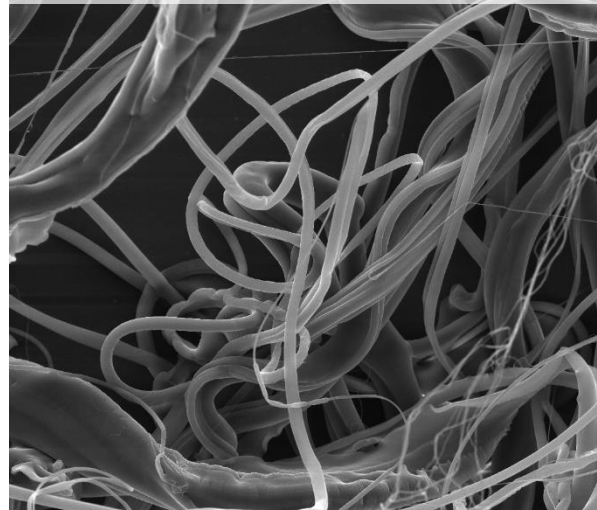
Vzorek 16: 20hm%PCL + CHCl 3 + DCHM Jehlové zvláknění, zvětšení: 500x
