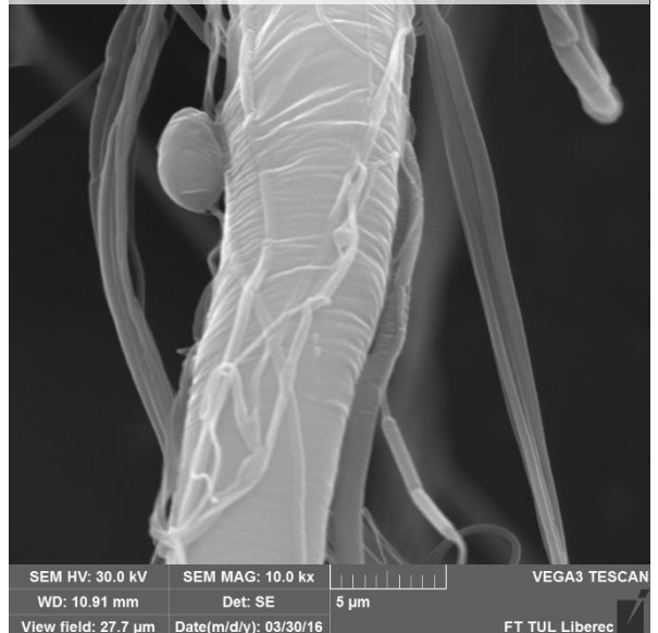
Vzorek 19: 16hm%PCL + CHCl 3 + EtOH Jehlové zvláknění, zvětšení: 5000x
