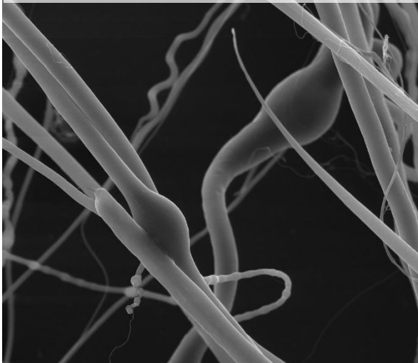
Vzorek 8: 20hm%PCL + CHCL 3 + EtOH Bezjehlové zvláknění, zvětšení: 1000x
