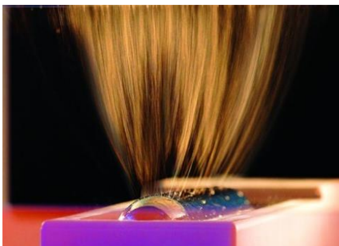
Obrázek 11: Zvlákňování na přístroji NanoSpider TH . Převzato z [23].
