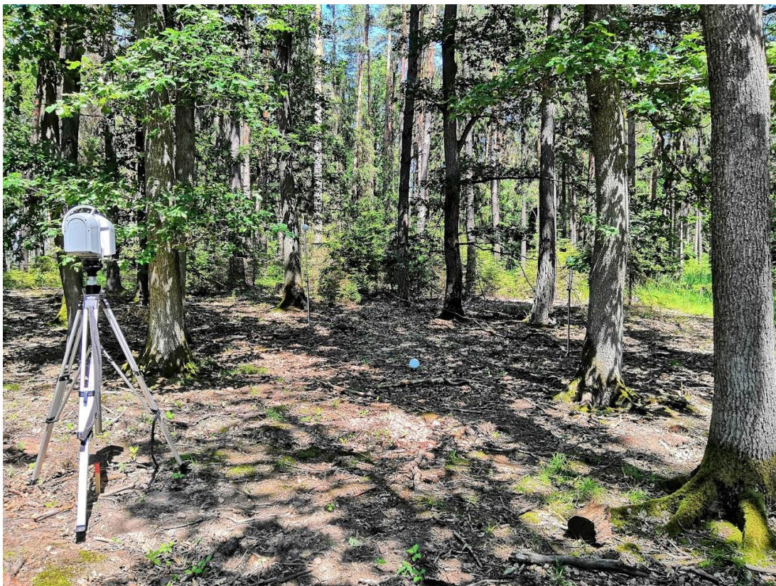
Obrázek 12 – Trimble TX8 na stanovisku při probíhající skenování daného porostu. V pozadí jsou vidět koregistrační sférické cíle. (Foto autor)
