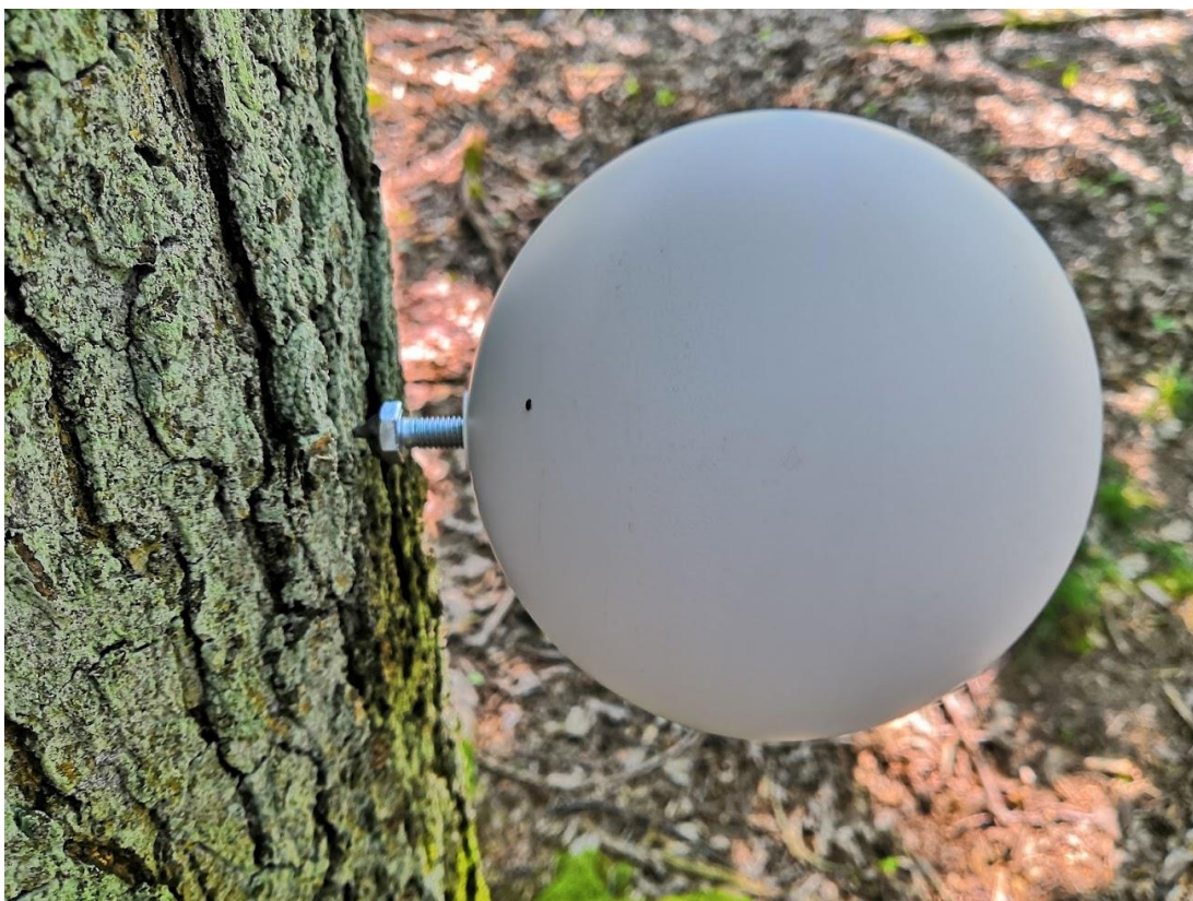
Obrázek 13 – Detail sférického cíle o rozměru 145 mm ukotveného v borce stromu. (Foto autor)
