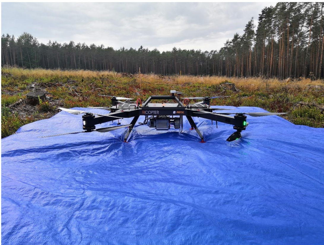
Obrázek 8 – VUX-SYS připravený ke vzletu a sběru dat (foto autor)
