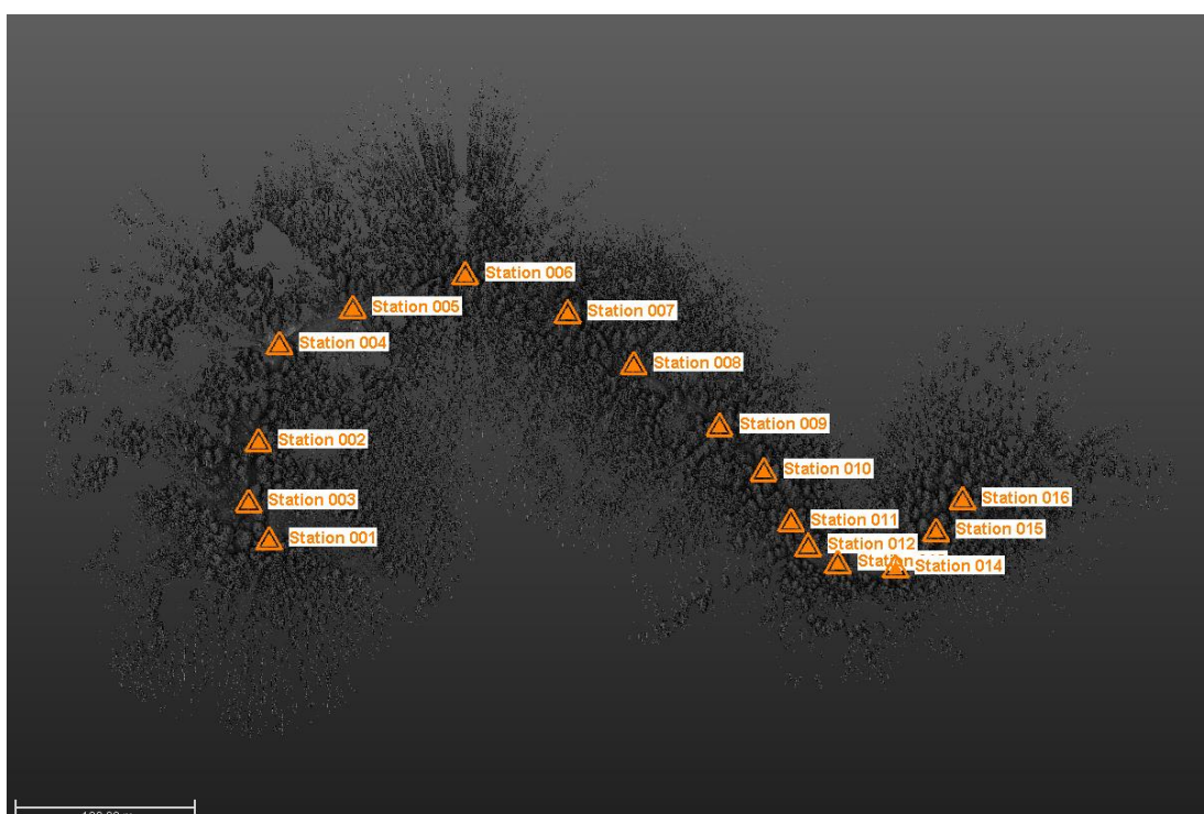
Obrázek 24 – Sběr dat pomocí TLS v linii (plocha NPCŠ).
