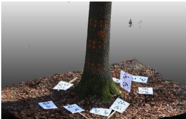
Obrázek 35 – Bodové mračno individuálního stromu s referenčními body pro měření tloušťky. Okolo jsou rozmístěny 16bitové tabulky pro referencování bodového mračna.
