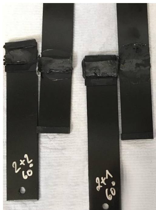
Obr. 35 Přetržené vzorky při 2 minutách ohřevu na 70 °C a 1 minutu ochlazování (vlevo 2 minuty ochlazování) v klimatické komoře
