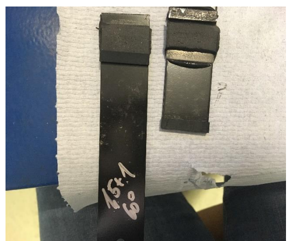
Obr. 30 Detail ideálního porušeného spoje
