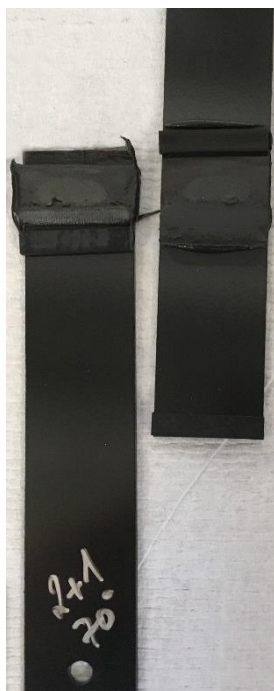
Obr. 33 Přetržený vzorek při 2 minutách ohřevu na 70 °C a 1 minutu ochlazování v klimatické komoře
