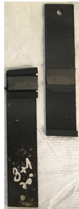
Obr. 34 Přetržený vzorek při 3 minutách ohřevu na 70 °C a 1 minutě ochlazování v klimatické komoře
