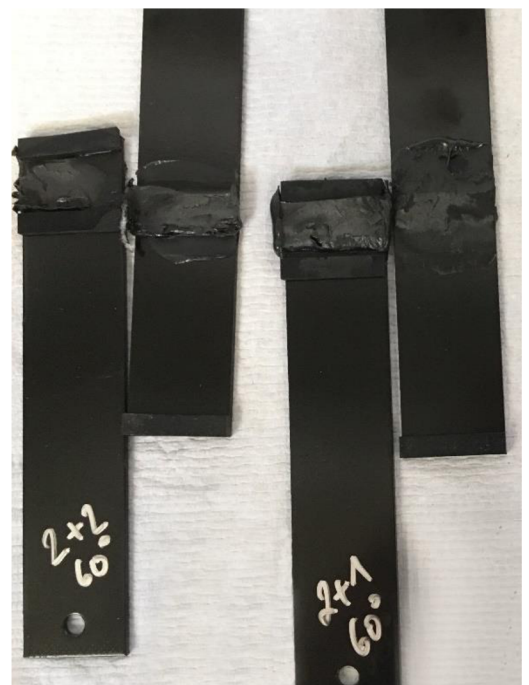
Obr. 35 Přetržené vzorky při 2 minutách ohřevu na 70 °C a 1 minutu ochlazování (vlevo 2 minuty ochlazování) v klimatické komoře
