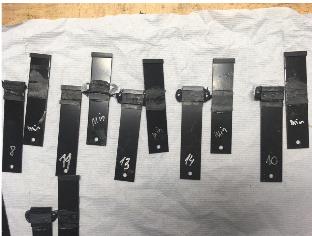
Obr. 27 Přetržené lepené spoje a znázornění postupu vytvrzení lepidla při teplotě okolí
