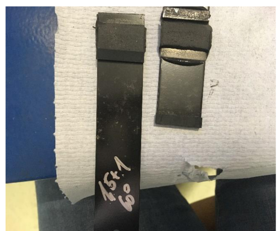
Obr. 30 Detail ideálního porušeného spoje
