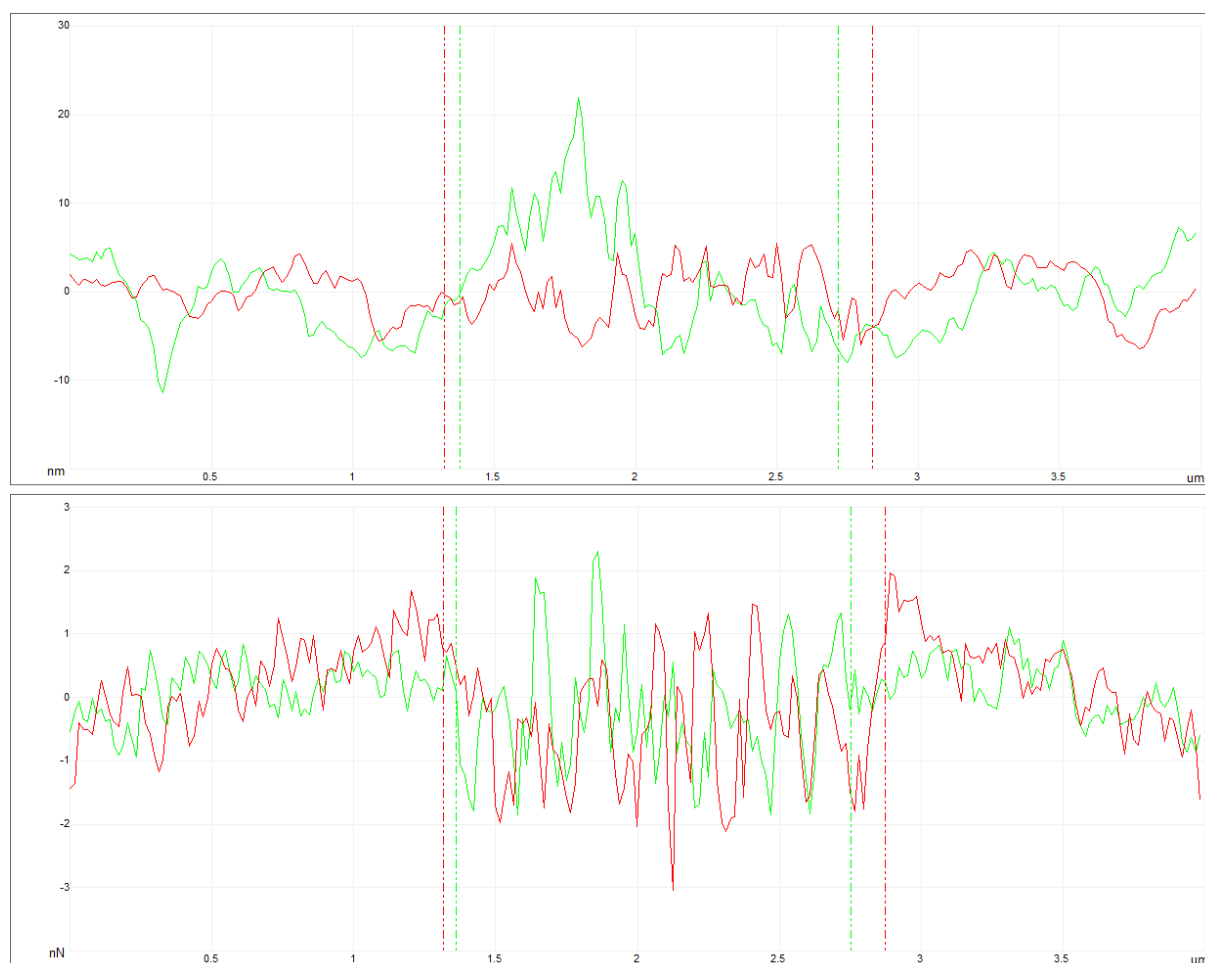
Obr. 86: Řezy výškovým (nahore) a adhezním (dole) kanálem pravidelné struktury na vzorku 6LN5
