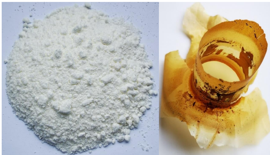
Obr. 19: Práškový dimer pro přípravu parylenu C (vlevo) a vrstva parylenu C sloupená ze stěny příruby depoziční komory (vpravo; po několika cyklech)
