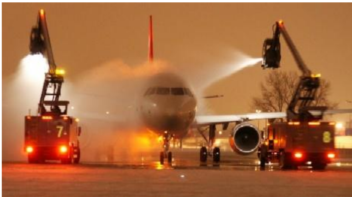
Obrázek 6: Postřik letadla nemrznoucí směsí zajišťuje bezpečnou leteckou dopravu v zimních měsících, ale vytváří odpadní vodu obsahující etynglykol (Mark, L. O., 2007).
