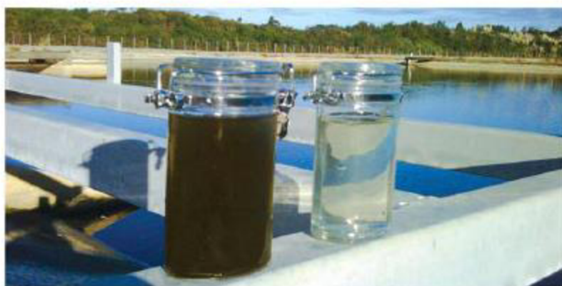
Obrázek 4: Porovnání přitékající průsakové vody ze skládky a odtékající vody ze systému umělých plovoucích ostrovů ( Demonstrating treatment of landfill leachate using floating treatment wetland technology, 2011).
