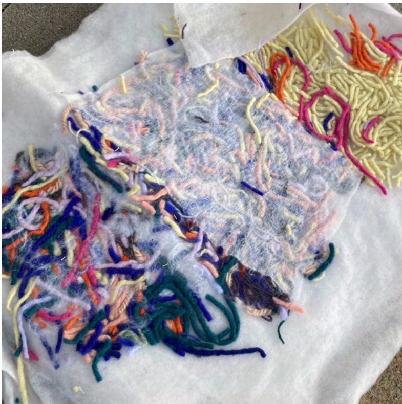
Obr. 40 Vzorek 9 – vpichování s pavučinou, jemnou netkanou textilií a bez pomocné vrstvy
