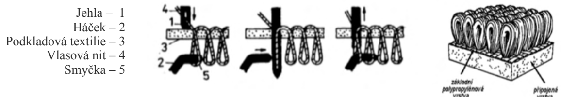
Obr. 6 Schéma tvorby smyčkového vlasu všíváním [20]
