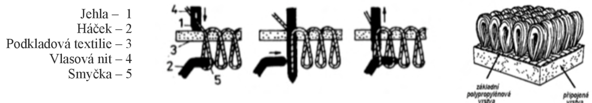
Obr. 6 Schéma tvorby smyčkového vlasu vsíváním [20]
