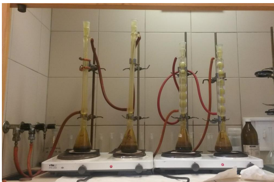
Obrázek 16: Rozklad vzorků půdy pod zpětnými chladiči.
