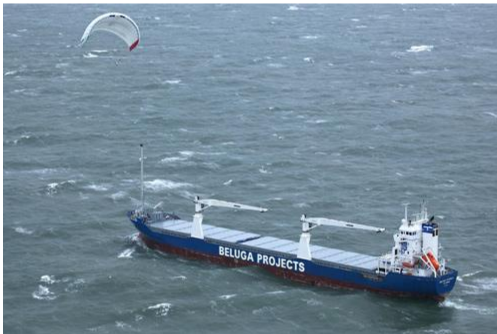
Obr. 22 – Využití padáku (SkySails) nákladní lodí. Dostupné online z: http://files.gereports.com/wp-content/uploads/2010/03/skysailsHouston_0041.jpg
