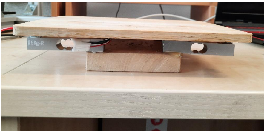
Obr. 47: Uložení bambusové desky na vážní systém.
