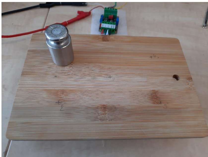
Obr. 48: Závaží umístěné v bodě 1 vážního systému.
