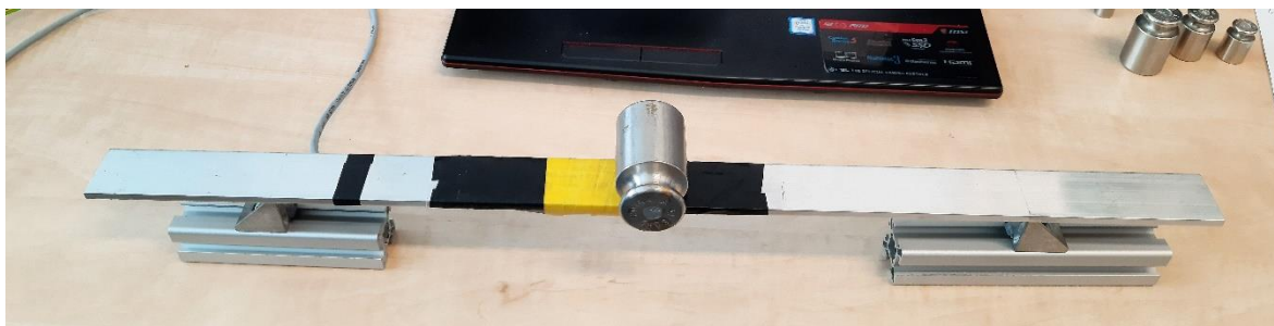
Obr. 35: Měření napětí u tříbodového ohybu.
