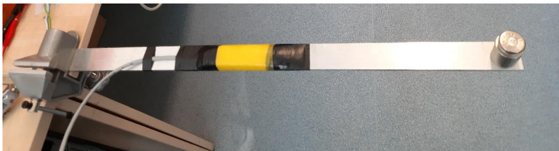
Obr. 24: Měření mechanického napětí na vetknutém nosníku.
