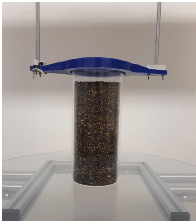
Obr. 59: Válec zaplněný semeny řepky před vysypáním.
