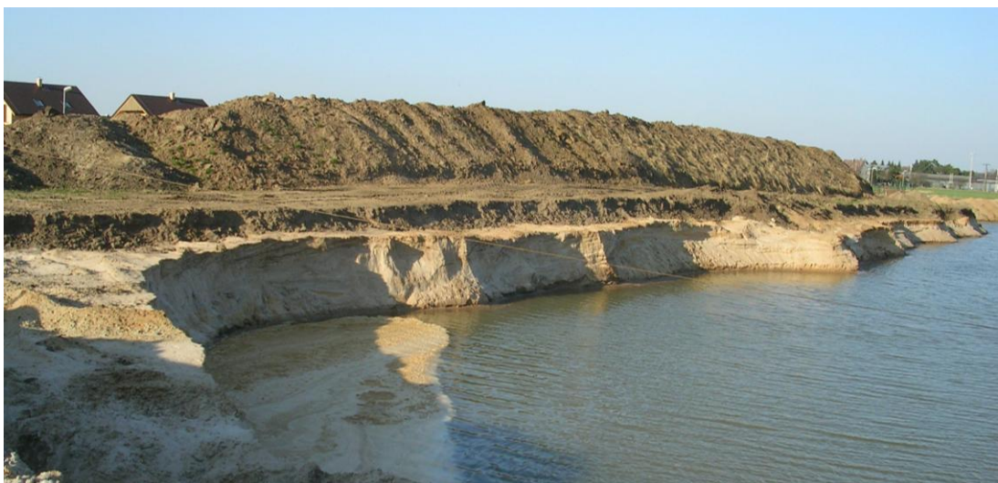
Obr. 2: Vrstva štěrkopísků v dobývacím prostoru Velký Osek I (foto: J. Braun, duben 2013)
