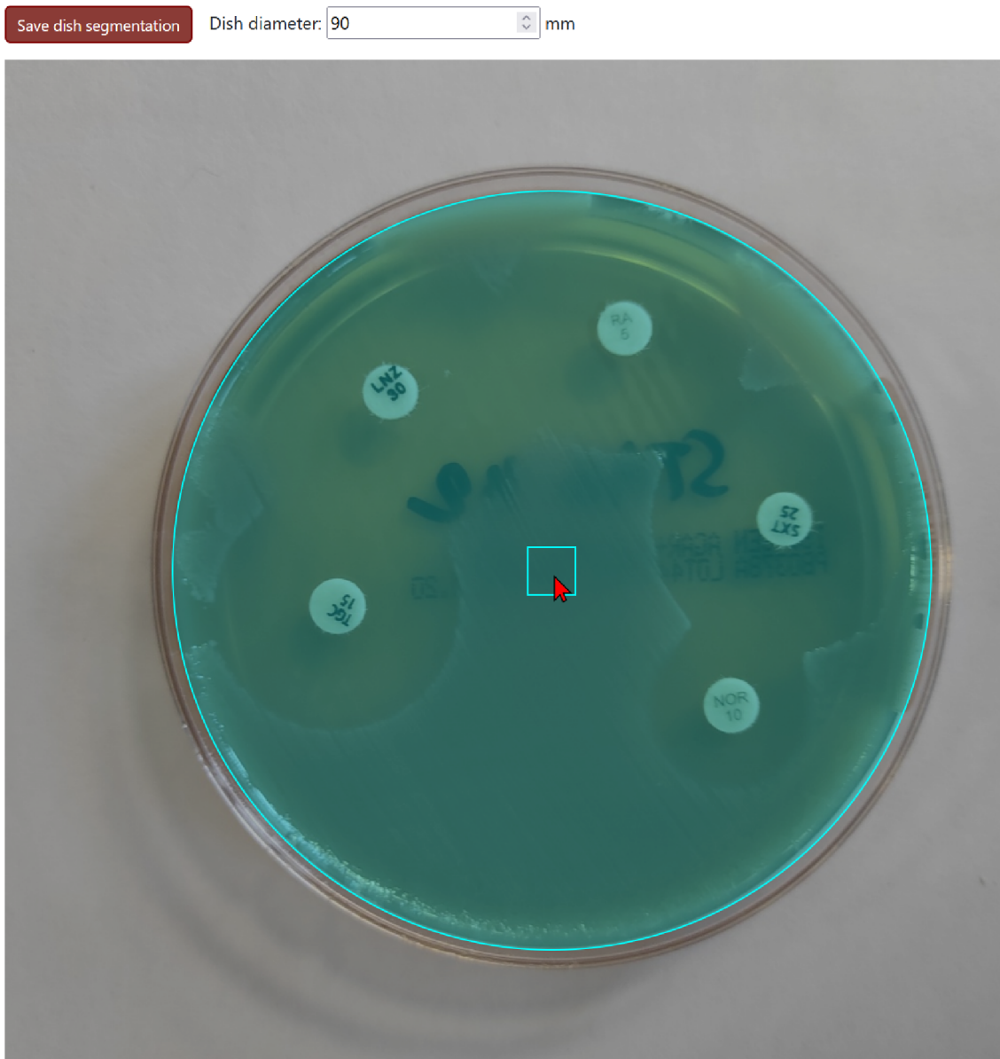
Obr. 5.4: Část webová aplikace, kde je umožněno uživateli vyklíčovat Petriho misku, a tak umožnit přepočet velikostí inhibičních zón v pixelech na milimetry.
