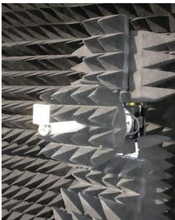
Obrázek 6.4 Měření osového poměru v anténní komoře
