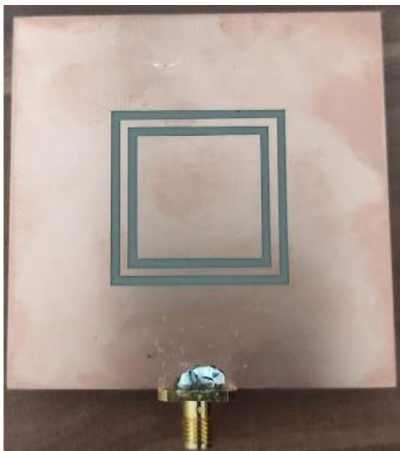
Obrázek 6.2 Vyrobená anténa (pohled na zemní plochu)
