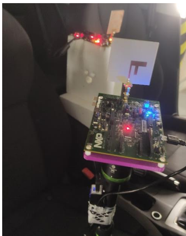
Obrázek 6.17 Ukázka měření vzdálenosti uvnitř automobilu
