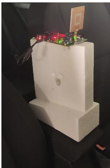
Obrázek 6.15 Umístění antény uvnitř auta mezi sedadly
