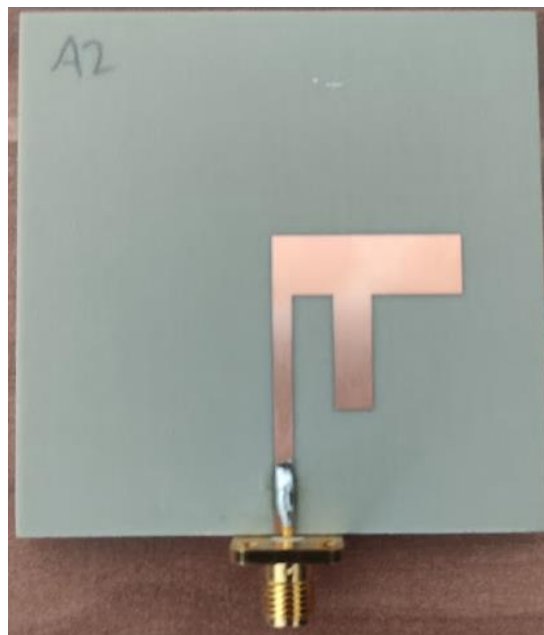
Obrázek 6.1 Vyrobená anténa (pohled na flíčkový zářič)
