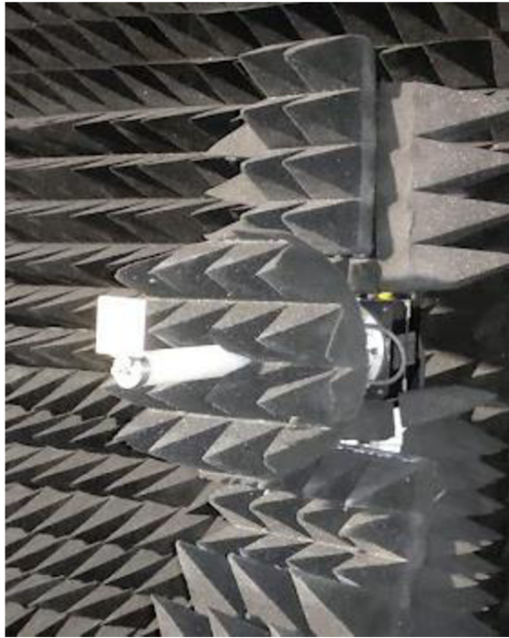
Obrázek 6.4 Měření osového poměru v anténní komoře
