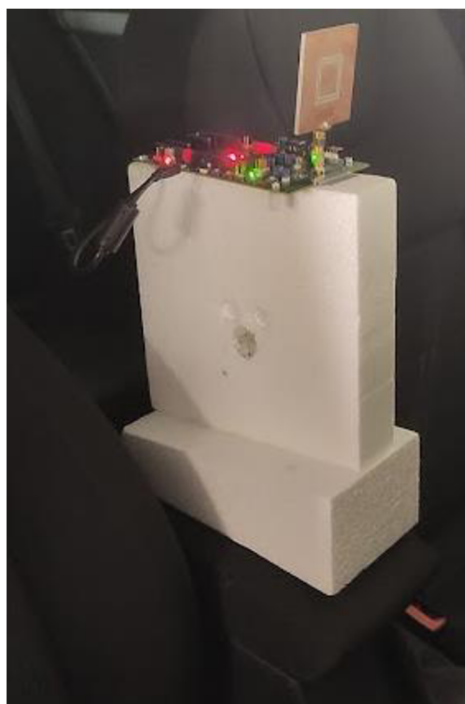
Obrázek 6.15 Umístění antény uvnitř auta mezi sedadly
