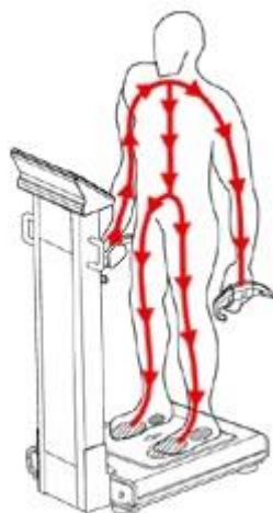
Obrázek 6. Způsob průchodu elektrického proudu lidským tělem (upraveno dle Inbody, 2009)
