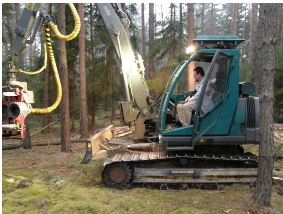
Obr. 21: Malý pásový harvestor Neuson. Nasazení v probírce borového porostu na pískách.
