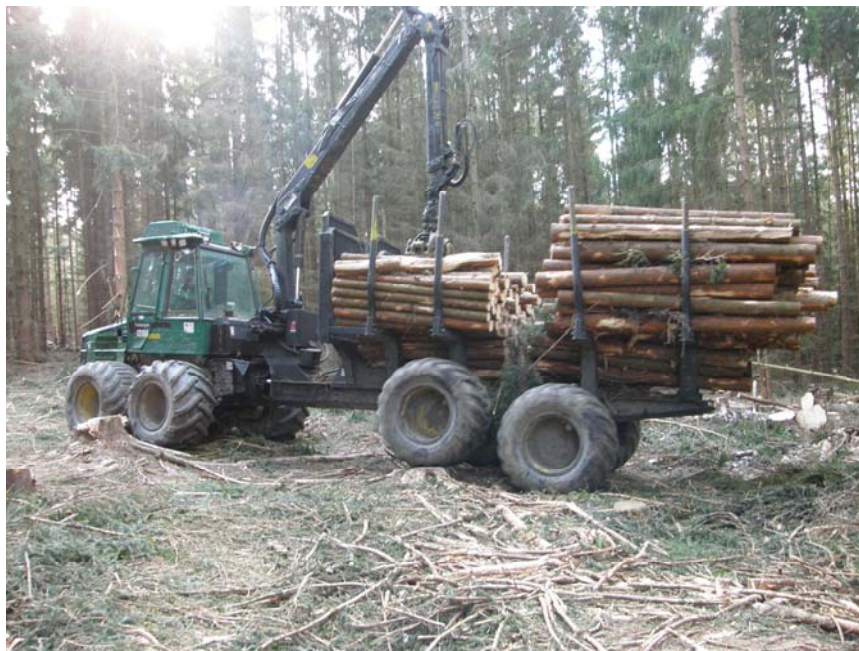
Obr. 22: Vyvážecí souprava Timberjack 1210B s dvou- a třímetrovými sortimenty
