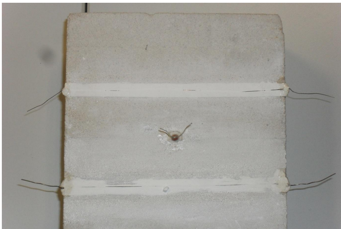
Obrázek č. 6: Vápenopísková cihla s připevněným odporovým drátkem a termistorem
