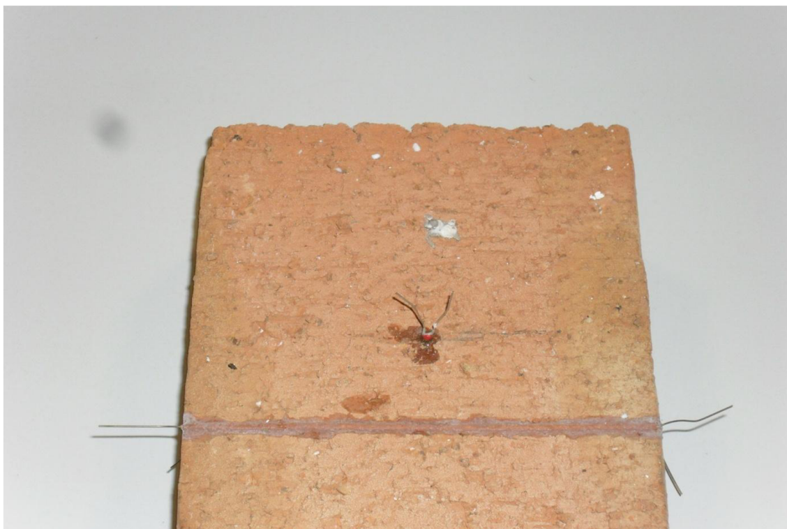
Obrázek č. 4: Pálená cihla s připevněným odporovým drátkem a termistorem
