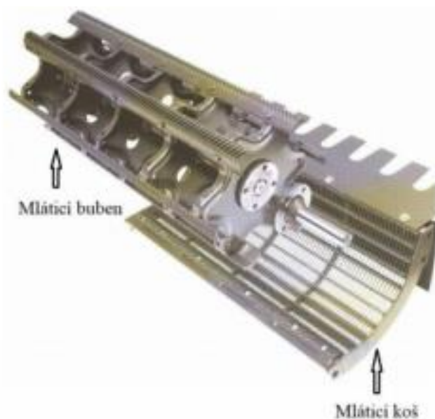
Obrázek 2.1: Tangenciální mláticí buben (Agroportal24h.cz, 6/2019)
