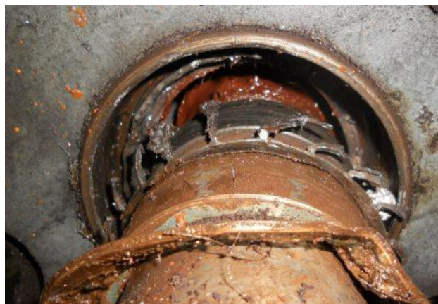
Obr. 18 Rozpadlá klec válečkového ložiska
