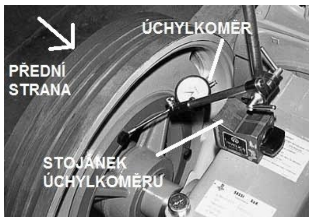
Obr. 12 Ukotvení stojánku s následným provedením měření opotřebení. Vertikální poloha stroje Alberto Sassi Leo
