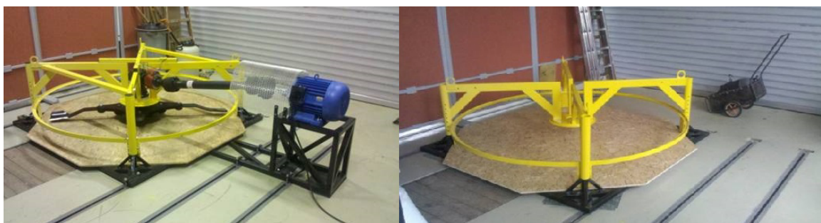
Obr. 33 Reálná konstrukce po svaření a lakování a Celková sestava modelu mulčovače včetně přípravku pro měření otáček a momentu a „ochranné klece“ na výstupu z motoru při minimální výšce nastavení hlavní části rámu
