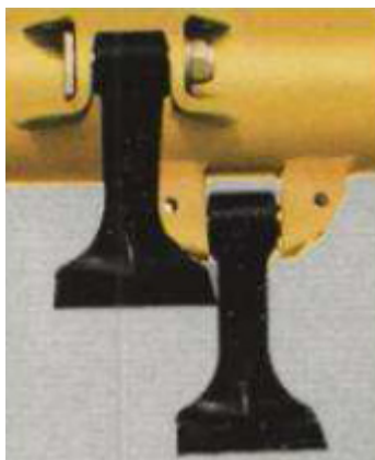
Obr. 4 Kladívka se hodí pro mulčování travin, listí a křovin
