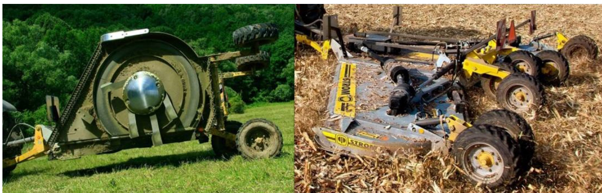
Obr. 8 Mulčovač s vertikální osou rotace - uložení pracovních orgánů a pohony
