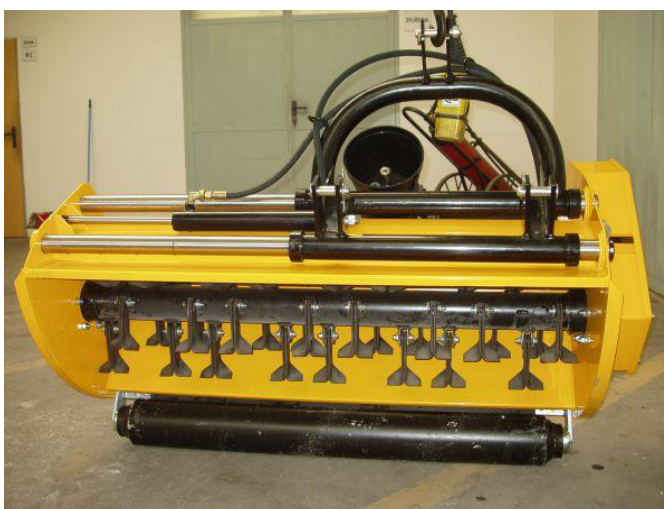
Obr. 3 Mulčovač s horizontální osou rotace a jedním hřídelem
