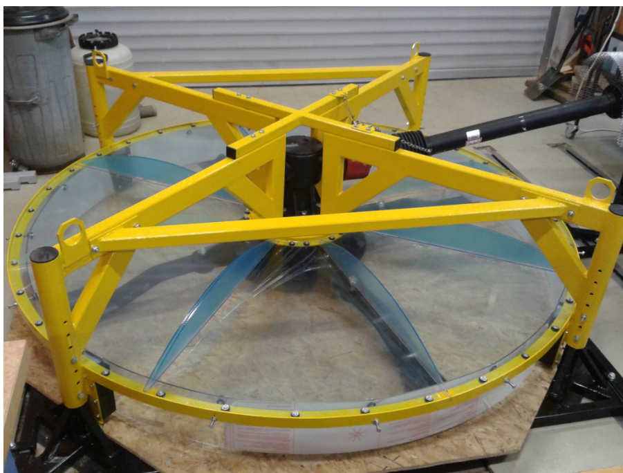
Obr. 34 Kompletní sestava modelu mulčovače včetně horních plochých krytů a bočnic nastavených na \phi 2120 mm a při minimální výšce nastavení hlavní části
