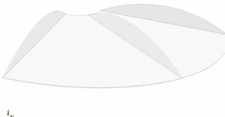
Obr. 19 Jedna čtvrtina horního plochého krytu s žebry pro zpevnění
