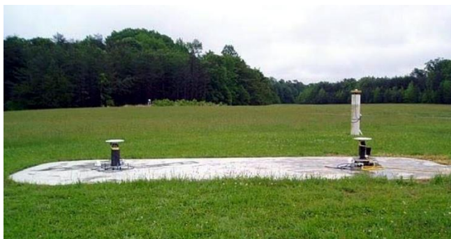
Obr. 7: Kalibrační základna v NGS (Bilich a Mader 2010)
