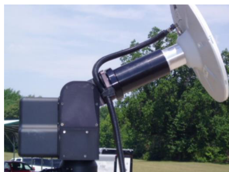
Obr. 8: Polohovací zařízení v NGS (Bilich a Mader 2010)
